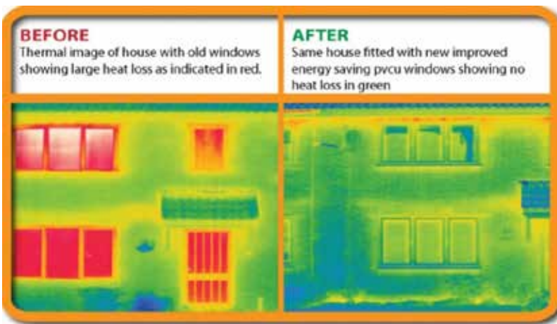
Şekil 5a Mevcut Pencere – Kapı ve Yalıtımlı PVC Pencere – Kapı Arasındaki Isısal Fark
